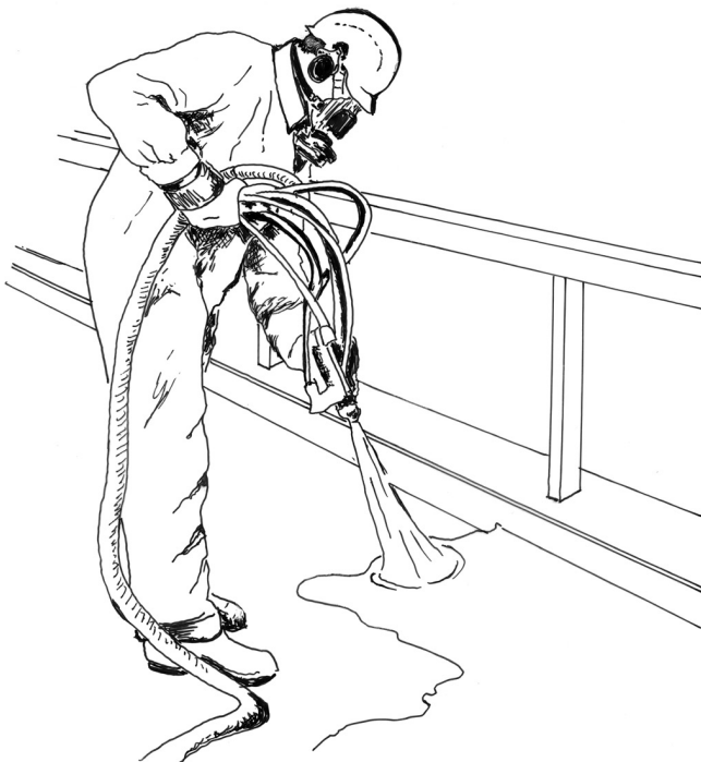
Kuva 29. Suojavarustus nestemäisiä eristysaineita levitettäessä (massaeristystyössä)
